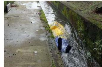
転落者(人型模型)による水位堰上げ状態の再現実験
