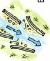
また、かすみ堤と呼ばれている堤防が、洪水の被害を少なくしているのだよ。
