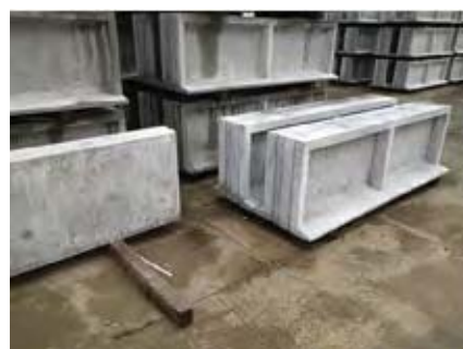
(畦畔ブロック: 延長2m、背面直型) 施工の効率化、畔際の耕起が容易になります
