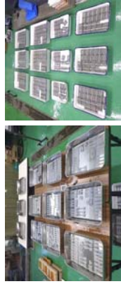
吸水、引張接着試験体 写真2 水中設置状況
