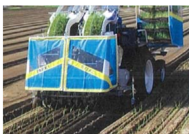
全自動乗用たまねぎ移植・施肥機 (PVT4Z-RTS240VAD改造機) ＋オートドライブ (TOPCON X25)
